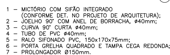
DETALHE TÍPICO DE INSTALAÇÃO DE ESGOTO PARA MICTÓRIO SEM ESCALA
